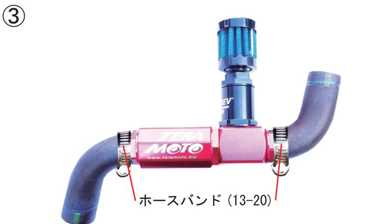
T-REV IN 側と T-REV OUT 側をホースバンド (13-20) で固定する。
