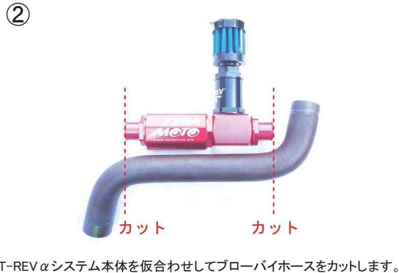
T-REV α システム本体を仮合わせしてブローバイホースをカットします。
