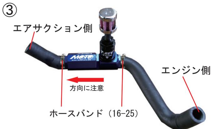
カットしたブローバイホースに T-REV を取り付け、ホースバンド (16-25) で固定する。
