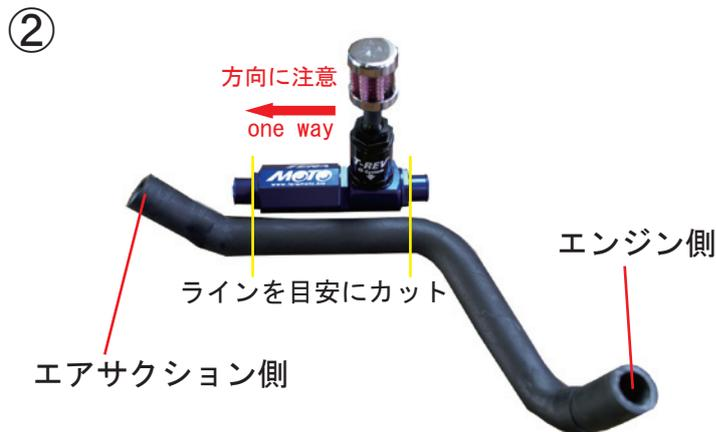
T-REV α システムを仮合わせしてブローバイホースをカットします。
