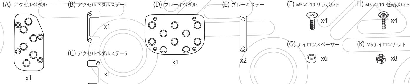
●取付けに使用する工具: 8mmスパナ・3mmヘキサゴンレンチ
