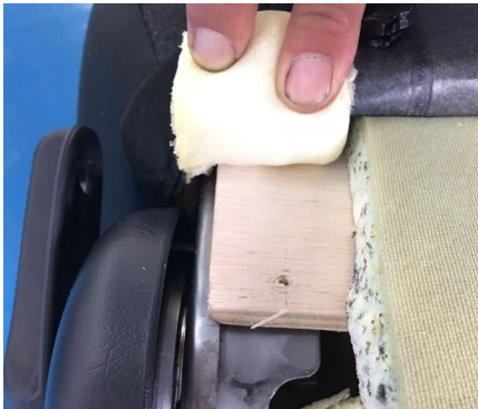
③ 手前左右の小さい穴に付属のビスで、板とフレームを留めて下さい。
