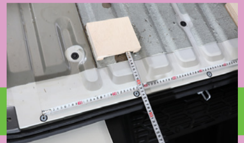
先の手順で外したエンドパネル固定ボルトの位置を基準に木製シムを仮置きして下さい。
