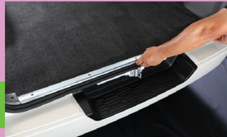
カーペットを戻し注1で外したエンドパネルを元に戻しボルトで固定して下さい。
