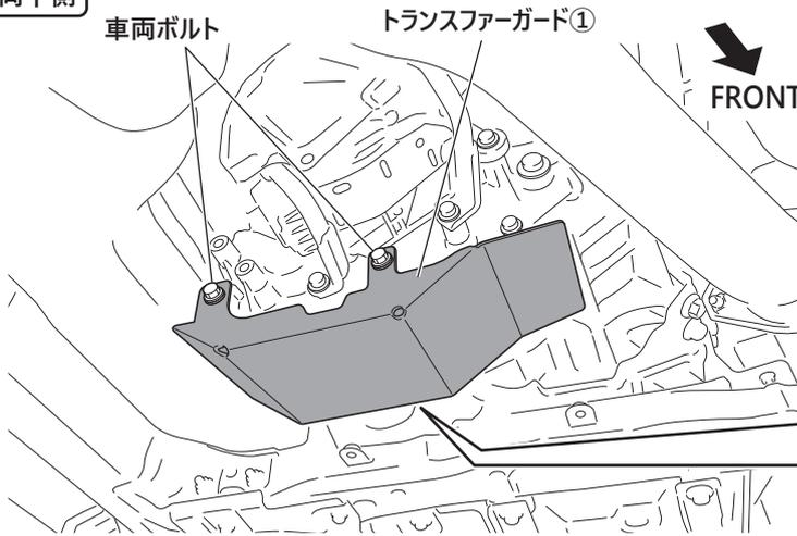
・純正トランスファーガードを取り外し、トランスファーガード本体①を車両ボルトで取り付けます。
