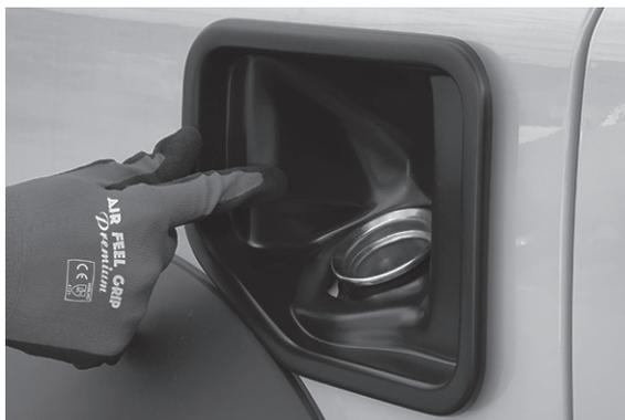
ボディ側接着面の脱脂を十分に行い、製品裏面左右の両面テープを使用し取り付けを行います。
