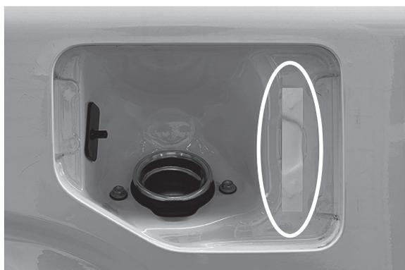
接着面の脱脂を十分に行い、付属しているシールを使用し、ボルト穴を保護します。
