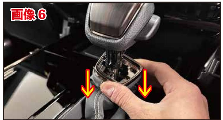
画像6-2 ○印部分の固定ピンはなくしやすいのでこの時点でシフトへ戻しておく事を推奨します。
